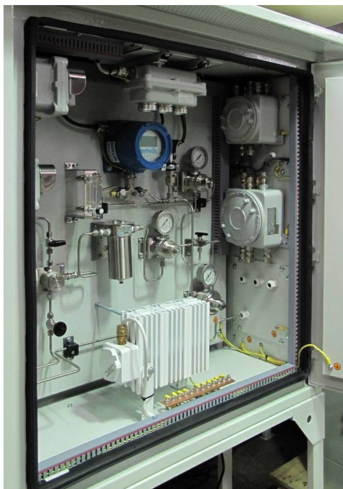
Рис. 2. Анализатор НУ-ОПТИМА, интегрированный с системой пробоподготовки, в погодозащищенном шкафу для установки на открытой площадке (с разрешения компании ООО «Технодизайн-М»). Взрывозащищенное исполнение.
