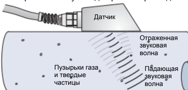
Монтаж датчика на трубе с помощью устройства с перфорированной лентой чрезвычайно прост. Датчик поставляется с кабелем длиной 3,5 м. По заказу поставляется удлинительный кабель для датчика 15 м. При изменении длины кабеля расходомер самонастраивается.
