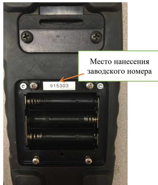
Рисунок 2 – Место нанесения заводского номера
