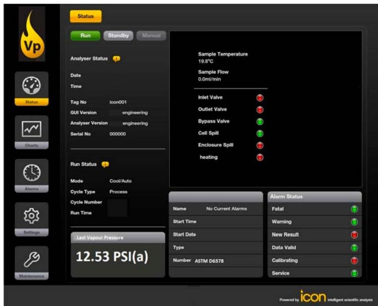
Рис. 3. Интерфейс пользователя анализатора ICON VapourPressure
